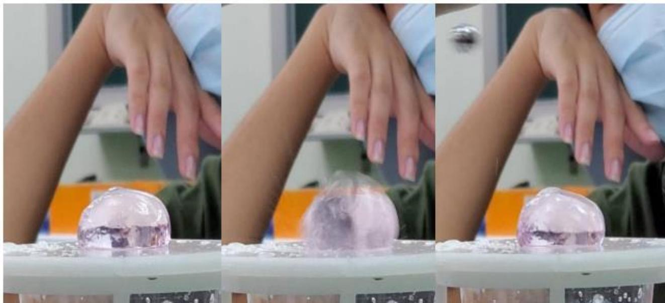
撞擊前(左)，撞擊中，鐵球在晶球凹下處(中)，撞擊後，鐵球反彈到高处，晶球無損傷(右)
