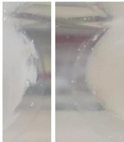
乳酸鈣冰球(左,白色)放入海藻酸鈉溶液中,冰球未融化時已長出海藻酸鈣膜(透明)的影像
