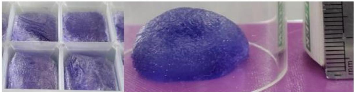
以海藻酸鈉冰球去浸泡乳酸鈣,形成的海藻酸鈣膜較粗糙
