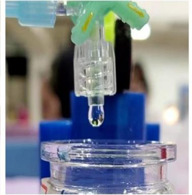
海藻酸鈉糖溶液(上方)與乳酸鈣水溶液(下方)滴定裝置
