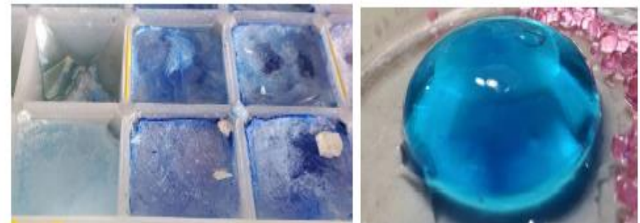
以海藻酸鈉冰球去浸泡乳酸鈣，形成的海藻酸鈣膜較粗糙
