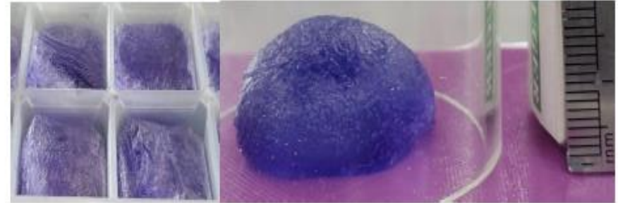
以海藻酸鈉冰球去浸泡乳酸鈣，形成的海藻酸鈣膜較粗糙
